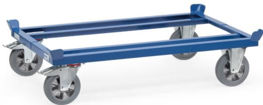
Für Flachpaletten und Gitterboxen. Robuste Winkelstahl-Schweißkonstruktion, mit 4 Fangecken, pulverbeschichtet, blau RAL 5007. 2 Lenk- und 2 Bockrollen, Elastic-Vollgummi-Bereifung, Naben mit Kugellager, blaugrau "spurlos", Feststeller an den Lenkrollen, gemäß der europäischen Norm EN 1757-3 (Sicherheit von Plattformwagen). Geringer Rollwiderstand, elastischer Lauf, keine Fahrgeräusche.
