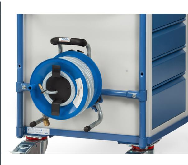
Druckluftschlauchtrommel als Anbausatz für Stahlblech-Werkstattwagen. Zusätzlich geeignet für die direkte Befestigung an einer Wand. Pulverbeschichtet blau RAL 5007. Mit 20 m Schlauch-NW 9. Abschließbar durch Vorhängeschloss (nicht im Lieferumfang enthalten). Für Modelle 2445, 2446, 2448, 2449, 2475, 2476, 2450/7016, 2452/7016, 2456/7016, 12450/7016, 12452/7016, 12456/7016, 5492, 5493, 5592, 5593, 5692, 5693
