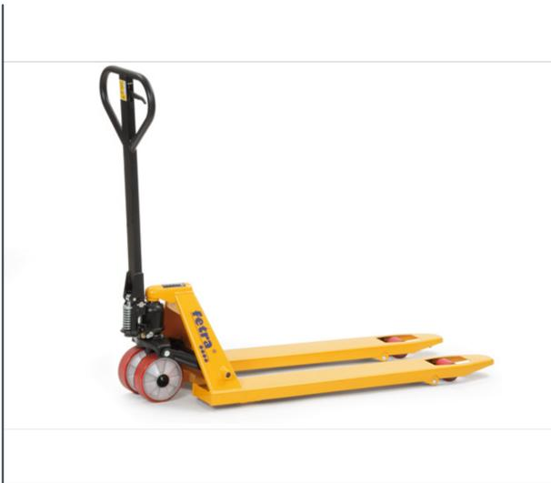
Rahmen und Gabeln in verwindungsfreier Schalenbauweise, gelb pulverbeschichtet. Hydraulische Handpumpe wartungsfrei gelagert. Stabile Stahlrohrdeichsel mit Gegenlager für Schubbetrieb, pulverbeschichtet schwarz, Deichselgriff pulverbeschichtet. Bedienhebel für die Funktionen: Heben - Fahren - Senken. Lenkeinschlag 2 x 100°. Beräderung: Geringer Rollwiderstand, nicht kreidend. 2 Jahre Garantie
