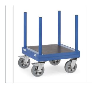
Profilstahl-Konstruktion mit einsteckbaren Stahlrohr-Rungen, pulverbeschichtet, blau RAL 5007. Wasserfeste Holzplattform. Beräderung: 4 Schwerlast-Lenkrollen. Räder: Elastic-Vollgummi blaugrau "spurlos", Naben mit Kugellager. 2 Lenkrollen mit Feststeller gemäß der Europäischen Norm EN 1757-3 (Sicherheit von Plattformwagen). Außenmaße (L x B x H) mm: 700 x 700 x 895 Ladehöhe 338 mm.
