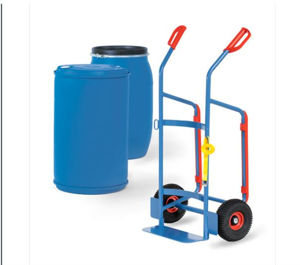
Fasskarre für den Transport von Kunststoff-Fässern mit 120-220 Liter Inhalt. Stahlrohr geschweißt, pulverbeschichtet, blau RAL 5007, dauerhaft oberflächengeschützt. Räder mit Luftbereifung, Naben mit Rollenlager. Spanngurt zur Fass-Sicherung.
