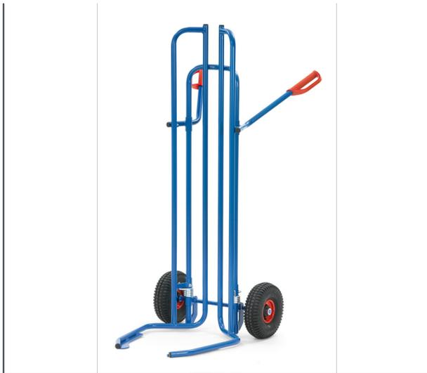
Stahlrohr geschweißt, pulverbeschichtet blau RAL 5007, dauerhaft oberflächengeschützt. Räder mit Vollgummibereifung. Naben mit Rollenlager. Mittels durch die Griffholme zu bedienende Spreiz-Aufnahmen können Reifenstapel direkt aufgenommen oder abgesetzt werden. Geeignet für Reifen von 450 bis 750 mm Ø. Bis zu 8 Reifen oder Räder möglich.
