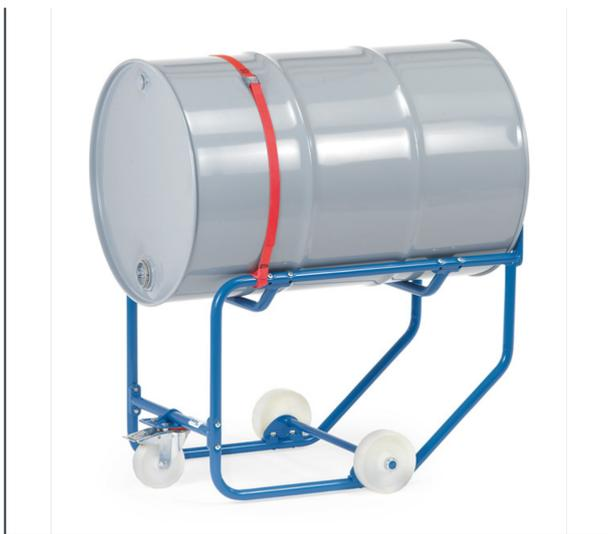
Zum Lagern und Entleeren von 200-Liter-Stahlfässern. Stahlrohr-Konstruktion, verschraubt, pulverbeschichtet blau RAL 5007. Spanngurt zur Fass-Sicherung. Einfacher Fasskipper ohne Hebelstange, fahrbar. Ohne Rollen zum Verdrehen der Fässer. Auflegen der Fässer durch Hebegerät oder Kran. Fahrbar. 1 Lenkrolle mit 125 x 38 mm und 2 Räder 150 x 40 mm. Lenkrolle mit Feststeller. Außenmaße LxBxH: 900 x 615 x 600 mm.
