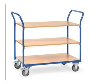
Profilstahl-/Stahlrohr-Schweißkonstruktion, pulverbeschichtet, brillantblau RAL 5007. 3 Böden aus Holzwerkstoffplatte, Oberfläche Buchendekor. 2 Lenk- und 2 Bockrollen, TPE-Bereifung, Naben mit Rillenkugellager. Feststeller an den Lenkrollen, gemäß der Europäischen Norm EN 1757-3 (Sicherheit von Plattformwagen). Tragkraft mittlere und obere Ladefläche 80 kg.
