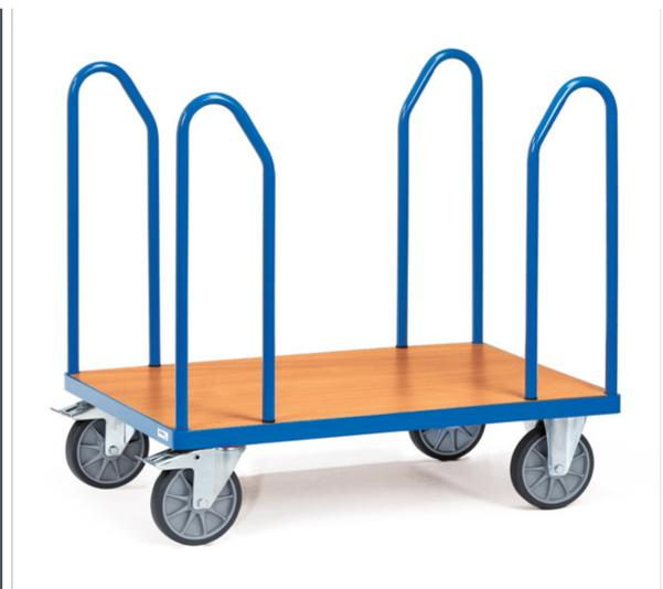
Stahlrohr und Profilstahl geschweißt, pulverbeschichtet RAL 5007, Plattform Holzwerkstoffplatte, Oberfläche Buchendekor. Mit 4 Bügeln. 2 Lenk- und 2 Bockrollen, TPE-Bereifung, Naben mit Rillenkugellager. Feststeller an den Lenkrollen, gemäß der Europäischen Norm EN 1757-3 (Sicherheit von Plattformwagen).
