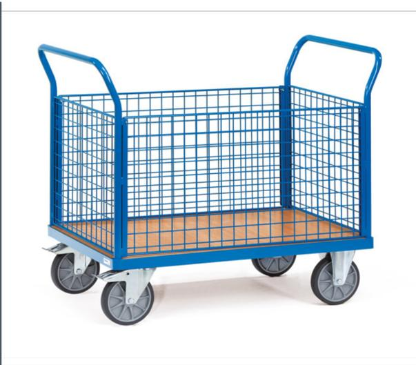
Stahlrohr und Profilstahl geschweißt, pulverbeschichtet RAL 5007, Plattform Holzwerkstoffplatte, Oberfläche Buchendekor. 2 Stirnwände und 2 Längswände aus Drahtgitter 50 x 50 x 4 mm, Wände 500 mm hoch. 2 Lenk- und 2 Bockrollen, TPE-Bereifung, Naben mit Rillenkugellager. Feststeller an den Lenkrollen, gemäß der Europäischen Norm EN 1757-3 (Sicherheit von Plattformwagen).
