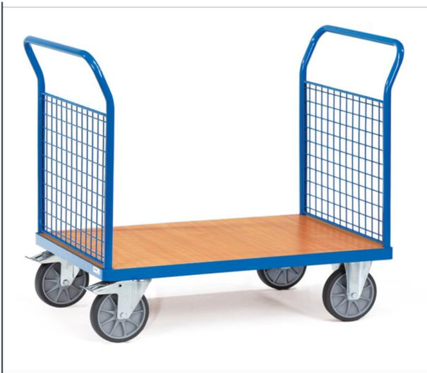
Stahlrohr und Profilstahl geschweißt, pulverbeschichtet RAL 5007, Plattform Holzwerkstoffplatte, Oberfläche Buchendekor. 2 Stirnwände aus Drahtgitter 50 x 50 x 4 mm, Wände 500 mm hoch. 2 Lenk- und 2 Bockrollen, TPE-Bereifung, Naben mit Rillenkugellager. Feststeller an den Lenkrollen, gemäß der Europäischen Norm EN 1757-3 (Sicherheit von Plattformwagen).
