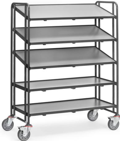
Eurokastenwagen im Baukasten-System: Stahlrohr und Profilstahl geschweißt, pulverbeschichtet anthrazitgrau RAL 7016, Schraubkonstruktion. 5 Etagenrahmen mit Holzwerkstoffplatten, Rand 13 mm hoch. Variabel einschraubbare Etagen, Raster 100 mm, Neigung bei schrägem Einbau 15° oder 30°. Tragkraft pro Ladefläche 60 kg. 4 Lenkrollen, TPE-Bereifung, Naben mit Rillenkugellager. 2 Stück mit Feststeller, gemäß der Europäischen Norm EN 1757-3 (Sicherheit von Plattformwagen).
