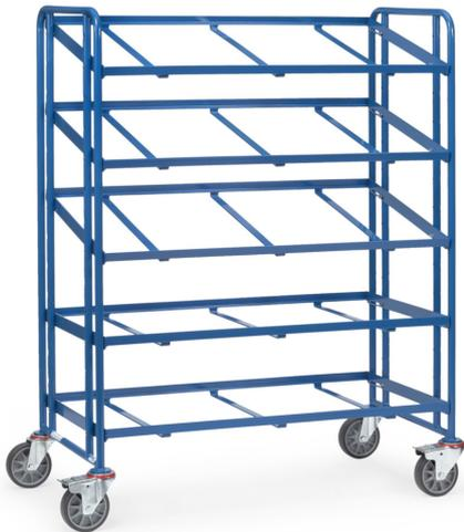
Eurokastenwagen im Baukasten-System: Stahlrohr und Profilstahl geschweißt, pulverbeschichtet blau RAL 5007, Schraubkonstruktion. Variabel einschraubbare Etagen im von Raster 100 mm möglich. Neigung bei schrägem Einbau 15° oder 30°. Tragkraft pro Ladefläche 80 kg. 5 Etagenrahmen passend für je 3 Eurokästen 600x400 mm. 4 Lenkrollen mit TPE-Bereifung und Naben mit Rillenkugellager. 2 Stück mit Feststeller, gemäß der Europäischen Norm EN 1757-3 (Sicherheit von Plattformwagen).
