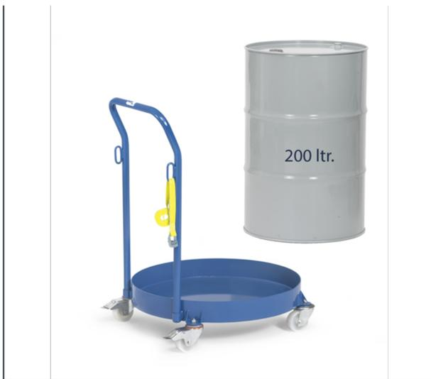
Für stehenden Transport von Stahlblechfässern mit 200 Litern Inhalt. Verschweißte Stahlkonstruktion, pulverbeschichtet brillantblau RAL 5007. Stahlblechwanne, öldicht verschweißt. Innen-Ø 630 mm. Rand 80 mm hoch. Mit anschraubbarem Rohrschiebebügel mit 2 Ösen und 1 Zurring. 4 Lenkrollen, 2 Stück mit Feststeller, Räder Polyamid, Naben mit Gleitlagerung.
