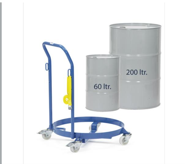
Fassroller für stehenden Transport von Stahlblech-Fässern mit 60 oder 200 Litern Inhalt. Geschweißte Flachstahl-Konstruktion, pulverbeschichtet brillantblau RAL 5007, Kreuzstreben nach unten durchgekröpft Ø 420 mm für 60-Ltr.-Fässer, Außenring Innen-Ø 610 mm für 200-Ltr.-Fässer. Mit anschraubbarem Rohrschiebebügel mit 2 Ösen und 1 Zurrurt. 4 Lenkrollen, 2 Stück mit Feststeller, Räder Polyamid, Naben mit Gleitlagerung.
