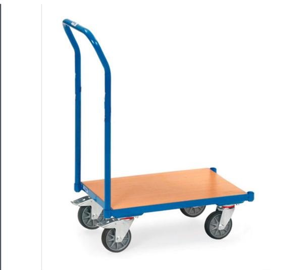
Winkelstahlkonstruktion mit mit Holzplattform bündig mit Rahmen und Schiebebügel. Pulverbeschichtet blau RAL 5007. 4 Lenkrollen mit TPE-Bereifung, Naben mit Rillenkugellager. 2 Stück mit Feststeller, gemäß der Europäischen Norm EN 1757-3 (Sicherheit von Plattformwagen). Passend für Eurokästen 600 x 400 mm.
