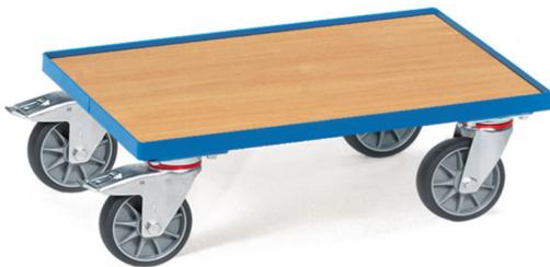
Eurokasten-Roller in Winkelstahlkonstruktion mit Boden aus Holzwerkstoffplatte, Rand 15 mm hoch. Pulverbeschichtet blau RAL 5007. 4 Lenkrollen mit TPE-Bereifung, Naben mit Rillenkugellager. 2 Stück mit Feststeller, gemäß der Europäischen Norm EN 1757-3 (Sicherheit von Plattformwagen). Passend für Eurokästen 600 x 400 mm.
