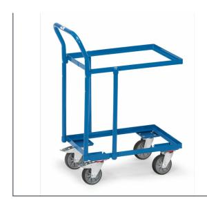
Etagen-Roller mit 2 Plattformen und Rohrschiebebügel, pulverbeschichtet blau RAL 5007. Zwei offene Rahmen zur Aufnahme von Eurokästen. Lichter Etagenabstand 500 mm. Tragkraft obere Ladefläche 100 kg. 4 Lenkrollen mit TPE-Bereifung, Naben mit Rillenkugellager. 2 Stück mit Feststeller, gemäß der Europäischen Norm EN 1757-3 (Sicherheit von Plattformwagen). Passend für Eurokästen 600 x 400 mm. Zerlegte Anlieferung.
