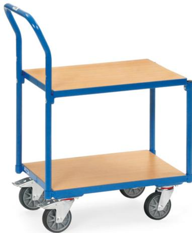
Etagen-Roller mit 2 Plattformen und Rohrschiebebügel. Beide Rahmen mit Böden aus Holzwerkstoffplatte, Oberfläche Buchendekor. Böden bündig mit Oberkante Rahmen. Pulverbeschichtet blau RAL 5007. Lichter Etagenabstand 400 mm, Gesamthöhe 970 mm. Tragkraft obere Ladefläche 100 kg. 4 Lenkrollen mit TPE-Bereifung, Naben mit Rillenkugellager. 2 Stück mit Feststeller, gemäß der Europäischen Norm EN 1757-3 (Sicherheit von Plattformwagen). Passend für Eurokästen 600 x 400 mm. Zerlegte Anlieferung.
