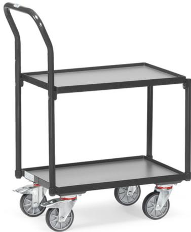
Etagen-Roller mit 2 Plattformen und Rohrschiebebügel. Beide Rahmen mit Böden aus Holzwerkstoffplatte, Oberfläche mittelgrau, Rand 15 mm hoch. Pulverbeschichtet anthrazitgrau RAL 7016.LICHTER Etagenabstand 400 mm. Tragkraft obere Ladefläche 100 kg. 4 Lenkrollen mit TPE-Bereifung, Naben mit Rillenkugellager. 2 Stück mit Feststeller, gemäß der Europäischen Norm EN 1757-3 (Sicherheit von Plattformwagen). Passend für Eurokästen 600 x 400 mm. Zerlegte Anlieferung.
