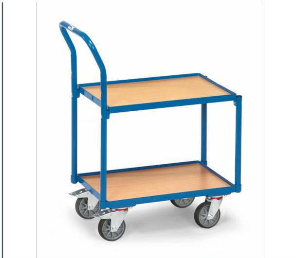
Etagen-Roller mit 2 Plattformen und Rohrschiebebügel. Beide Rahmen mit Böden aus Holzwerkstoffplatte, Oberfläche Buchendekor, Rand 15 mm hoch. Pulverbeschichtet blau RAL 5007. Lichter Etagenabstand 400 mm. Tragkraft obere Ladefläche 100 kg. 4 Lenkrollen mit TPE-Bereifung, Naben mit Rillenkugellager. 2 Stück mit Feststeller, gemäß der Europäischen Norm EN 1757-3 (Sicherheit von Plattformwagen). Passend für Eurokästen 600 x 400 mm. Zerlegte Anlieferung.
