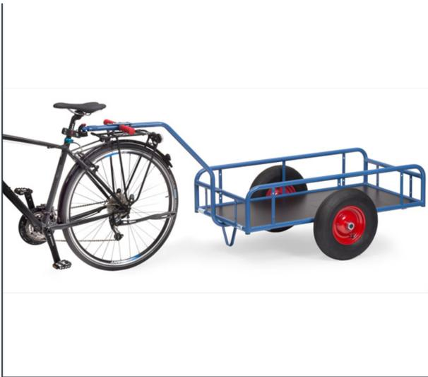
Für Handwagen 4103 – 4105 und 4107 – 4109. Anbausatz bestehend aus Kugelkupplung und Adapter für Sattelstützen von 26 bis 31 mm Durchmesser und Kugelschale mit Anschraubplatten an Standarddeichsel. Zuladung max. 40 kg Aufliege­last max. 4 kg. Nachrüstbar. Für Handwagen mit Fahrradkupplungen werden Folienreflektorstreifen kostenlos mitgeliefert. 2 x rot und 4 x weiß.
