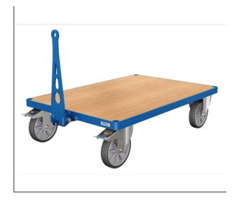
Für den Transport mit Zugfahrzeugen bis 6 km/h. Züge bis 5 Wagen möglich. Maximales Zuggewicht 2.000 kg. Deichsel aus Flachstahl profiliert, stellt sich mittels Gasdruckfedern selbsttätig in senkrechte Ruheposition. An der Bockrollenseite befindet sich ein stabiler Kupplungsbolzen. Verbindung durch Fußbetätigung möglich.
