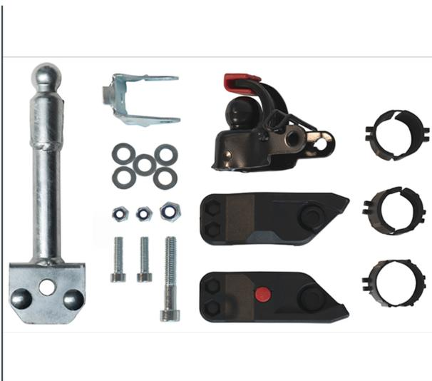
Anbausatz feuerverzinkt bestehend aus Kugelkupplung und Adapter für Sattelstützen von 26 bis 31 mm Durchmesser und Kugelschale mit Anschraubplatten an Standarddeichsel. Zuladung max. 40 kg, Aufliegebelastung max. 4 kg. Nachrüstbar.
