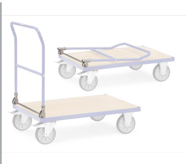
Klappgelenk als Zubehör für MultiVario - Schiebebügelwagen, Stirnwandwagen oder Doppel-Stirnwandwagen. Selbsttätige Arretierung, lösen per Fußtritt. Kompatibel mit Artikel: 2503, 2513, 1513, 2523, 1523
