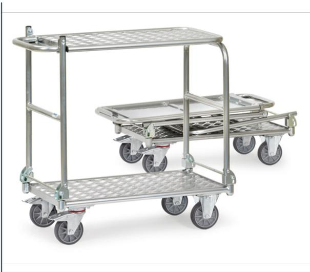
Alurohrwagen mit Aluplattform. Mit 2 klappbaren Bügeln und mit klappbarer Tischplattform. 2 Lenk- und 2 Bockrollen, TPE-Bereifung (spurlos), Naben mit Rillenkugellager. Feststeller an den Lenkrollen, gemäß der Europäischen Norm EN 1757-3 (Sicherheit von Plattformwagen). Tragkraft obere Ladefläche 80 kg. Deutsches Patent 100 62 425.
