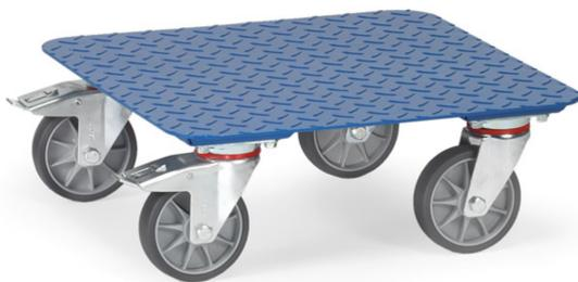
Aus Winkelstahl, mit Stahl-Tränenblech-Plattform, geschweißt, pulverbeschichtet blau RAL 5007. 4 Lenkrollen, TPE-Bereifung, Naben mit Rillenkugellager. 2 Stück mit Feststeller, gemäß der Europäischen Norm EN 1757-3 (Sicherheit von Plattformwagen).
