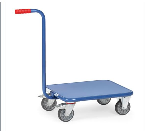
Stahlrohr geschweißt, mit Stahlblechplattform, Plattform mit bündig eingeschweißtem Stahlblech 2 mm stark. Pulverbeschichtet brillantblau RAL 5007. Griff anschraubbar. 2 Lenk- und 2 Bockrollen, TPE-Bereifung (spurlos), Naben mit Rillenkugellager, Feststeller an den Lenkrollen, gemäß der Europäischen Norm EN 1757-3 (Sicherheit von Plattformwagen).
