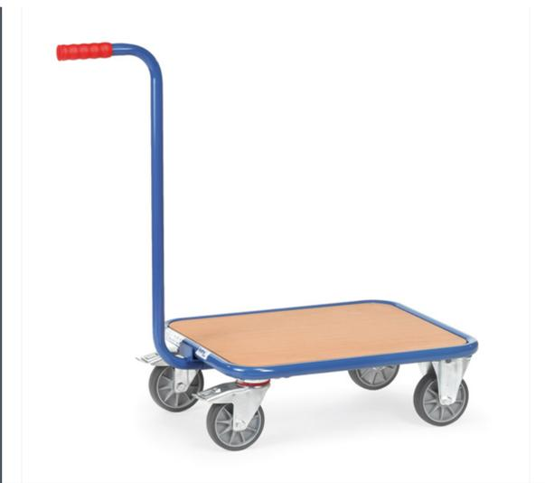
Griffroller aus Stahlrohr geschweißt, pulverbeschichtet brillantblau RAL 5007. Mit Holzplattform, Plattform mit im Rahmen liegender Holzwerkstoffplatte, Oberfläche Buchendekor. Griff anschraubbar. 2 Lenk- und 2 Bockrollen, TPE-Bereifung (spurlos), Naben mit Rillenkugellager, Feststeller an den Lenkrollen, gemäß der Europäischen Norm EN 1757-3 (Sicherheit von Plattformwagen).
