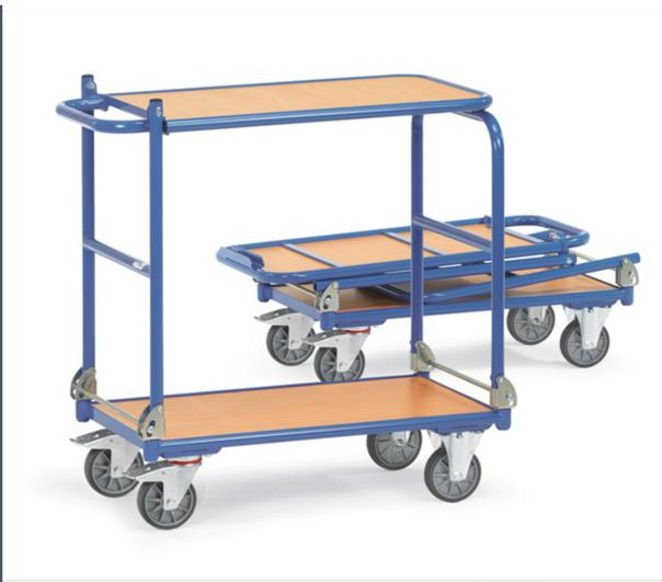
Stahlrohr-Tischwagen, pulverbeschichtet brillantblau RAL 5007, Ladefläche aus Holzwerkstoffplatte, Oberfläche Buchendekor. Mit 2 klappbaren Bügeln und mit klappbarer Tischplattform. 2 Lenk- und 2 Bockrollen, TPE-Bereifung, Naben mit Rillenkugellager. Feststeller an den Lenkrollen, gemäß der Europäischen Norm EN 1757-3 (Sicherheit von Plattformwagen). Tragkraft obere Ladefläche 80 kg. Deutsches Patent 100 62 425.
