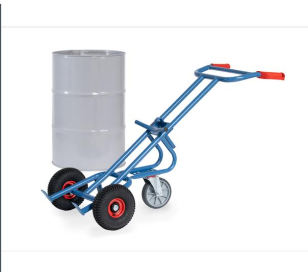
Fasskarre aus Stahlrohr geschweißt, pulverbeschichtet, blau RAL 5007, dauerhaft oberflächengeschützt. Räder mit Luftbereifung, Naben mit Rollenlager. Für alle 200-Liter-Fässer mit Rand geeignet. Zusätzlich mit 1 Stütz-Lenkrolle TPE 200 x 40 mm.
