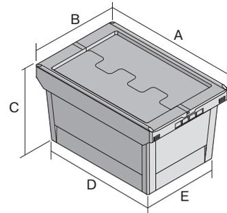
Pos. Abmessungen, Toleranzen nach DIN 16901
