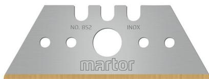
Die TRAPEZKLINGE NR. 852 von MARTOR ist eine hochwertige Klinge aus rostfreiem Stahl inkl. TiN-Beschichtung. Sie ist sehr scharf und verfügt über zwei nacheinander nutzbare Schneidkanten für eine höhere Einsatzzeit. Die Klinge ist 53 mm lang, 19 mm breit und 0,63 mm stark. Das für die Klinge verwendete Öl ist lebensmittelecht.
