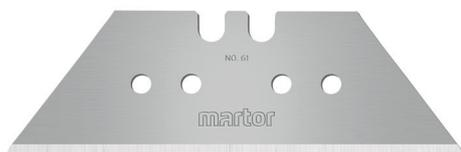
Die TRAPEZKLINGE NR. 61 von MARTOR ist eine hochwertige Klinge aus Stahl. Sie ist sehr scharf und verfügt über zwei nacheinander nutzbare Schneidkanten für eine höhere Einsatzzeit. Die Klinge ist 60 mm lang, 19 mm breit und 0,63 mm stark.
