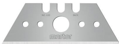
Die TRAPEZKLINGE NR. 610 von MARTOR ist eine hochwertige Klinge aus rostfreiem Stahl. Sie ist sehr scharf und verfügt über zwei nacheinander nutzbare Schneidkanten für eine höhere Einsatzzeit. Die Klinge ist 53 mm lang, 19 mm breit und 0,63 mm stark. Das für die Klinge verwendete Öl ist lebensmittelecht.
