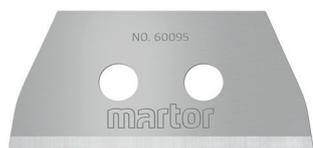
Die TRAPEZKLINGE NR. 60095 von MARTOR ist eine hochwertige Klinge aus Stahl. Sie ist sehr scharf und verfügt über zwei nacheinander nutzbare Schneidkanten für eine längere Einsatzzeit. Die Klinge ist 40,0 mm lang, 19,0 mm breit und 0,63 mm stark. Der Breitschliff erleichtert das Schneiden, die abgerundeten Spitzen erhöhen Ihre Sicherheit.
