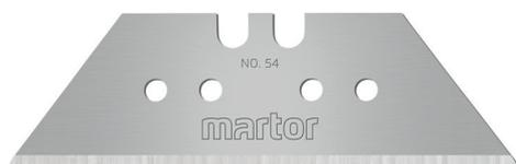
Die TRAPEZKLINGE NR. 54 von MARTOR ist eine hochwertige Klinge aus Stahl. Sie ist sehr scharf und verfügt über zwei nacheinander nutzbare Schneidkanten für eine höhere Einsatzzeit. Die Klinge ist 61 mm lang, 18,7 mm breit und 0,63 mm stark.
