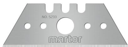
Die TRAPEZKLINGE NR. 5233 von MARTOR ist eine hochwertige Klinge aus Stahl. Sie ist sehr scharf und verfügt über zwei nacheinander nutzbare Schneidkanten für eine höhere Einsatzzeit. Die Klinge ist 53 mm lang, 19 mm breit und 0,63 mm stark.
