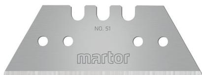
Die TRAPEZKLINGE NR. 51 von MARTOR ist eine hochwertige Klinge aus Stahl. Sie ist sehr scharf und verfügt über zwei nacheinander nutzbare Schneidkanten für eine höhere Einsatzzeit. Die Klinge ist 53 mm lang, 19 mm breit und 0,63 mm stark.
