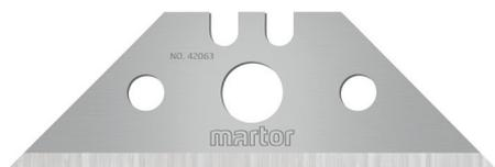
Die TRAPEZKLINGE NR. 42063 von MARTOR ist eine hochwertige Klinge aus Stahl. Sie ist sehr scharf und verfügt über zwei nacheinander nutzbare Schneidkanten für eine höhere Einsatzzeit. Der Breitschliff erleichtert das Schneiden. Die Klinge ist 58,4 mm lang, 19 mm breit und 0,63 mm stark.
