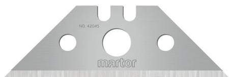
Die TRAPEZKLINGE NR. 42045 von MARTOR ist eine hochwertige Klinge aus Stahl. Sie ist sehr scharf und verfügt über zwei nacheinander nutzbare Schneidkanten für eine höhere Einsatzzeit. Der Breitschliff erleichtert das Schneiden. Die Klinge ist 58,4 mm lang, 19 mm breit und 0,45 mm stark.
