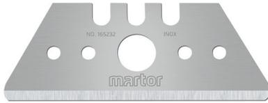
Die TRAPEZKLINGE NR. 165232 von MARTOR ist eine hochwertige Klinge aus rostfreiem Stahl. Sie ist sehr scharf und verfügt über zwei nacheinander nutzbare Schneidkanten für eine höhere Einsatzzeit. Die Klinge ist 50,1 mm lang, 19 mm breit und 0,63 mm stark. Der Breitschliff erleichtert das Schneiden, die abgerundeten Spitzen erhöhen Ihre Sicherheit. Das für die Klinge verwendete Öl ist lebensmittelecht.
