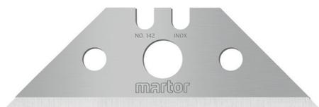
Die TRAPEZKLINGE NR. 142 von MARTOR ist eine hochwertige Klinge aus rostfreiem Stahl. Sie ist sehr scharf und verfügt über zwei nacheinander nutzbare Schneidkanten für eine höhere Einsatzzeit. Der Breitschliff erleichtert das Schneiden. Die Klinge ist 58,4 mm lang, 19 mm breit und 0,45 mm stark. Das für die Klinge verwendete Öl ist lebensmittelecht.
