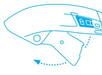
Danach drehen Sie den **Hebel aus dem Griff** heraus und öffnen Sie die Klingenabdeckung.
