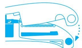
Zuletzt klappen Sie die **obere Griffhälfte wieder herunter**, bis sie einrastet. Bitte Klingenrückzug überprüfen!
