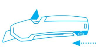
Fixieren Sie den Hebel mit der Sicherung und drehen Sie den Griff so, dass die **transparente Klingendeckung nach oben** zeigt.
