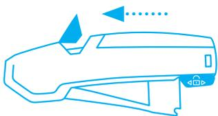
Ziehen Sie den **Klingenwechselknopf** nach oben heraus und betätigen Sie den Hebel. Klinge und Klingenthalerung treten aus dem Griff heraus.
