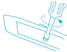
Lösen Sie die Schraube des Griffs und nehmen Sie die obere Griffhälfte ab. Nun können Sie die Klinge wenden oder wechseln.
