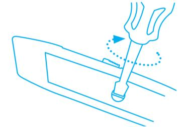
Für den Zusammenbau legen Sie die obere Griffhälfte zurück auf die untere und ziehen die Schraube **handfest** an.
