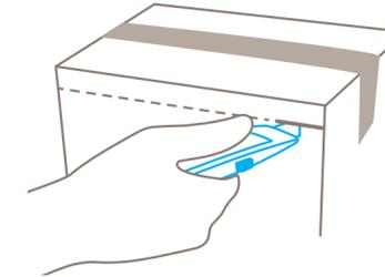
Nehmen Sie den **Daumen vom Schieber**, damit der automatische Klinsenrückzug funktioniert.
