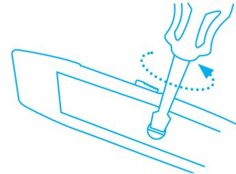
**Lösen** Sie die Schraube des Griffs und nehmen Sie die obere Griffhälfte ab.
