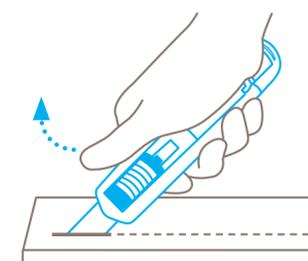
Nehmen Sie den **Daumen vom Schieber**, damit der automatische Klinsenrückzug funktioniert.
