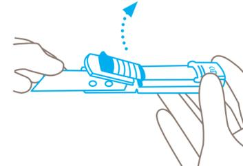
Klinge an der **stumpfen** Seite anfassen und mit ihrer Hilfe die Klinsenabdeckung nach oben hebeln. Die Abdeckung verbleibt in der geöffneten Stellung.
