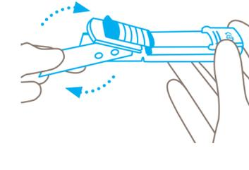
Klinge entnehmen und wechseln. Achten Sie darauf, die Klinge wieder **genau auf die Nocken** zu legen. Linkshänder drehen die Klinge um 180°.
