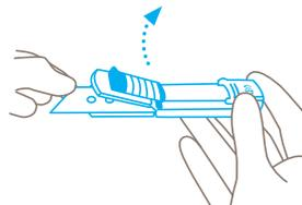
Klinge an der **stumpfen** Seite anfassen und mit ihrer Hilfe die Klingenabdeckung nach oben hebeln. Die Abdeckung verbleibt in der geöffneten Stellung.
